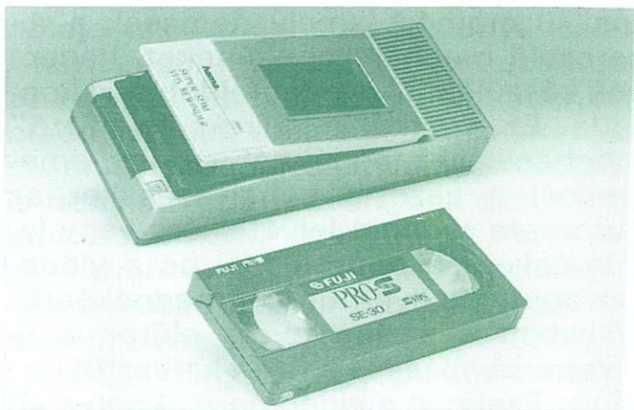
39. ábra Egyszerű felépítésű VHS-rendszerű szalagtekerceselő készülék
