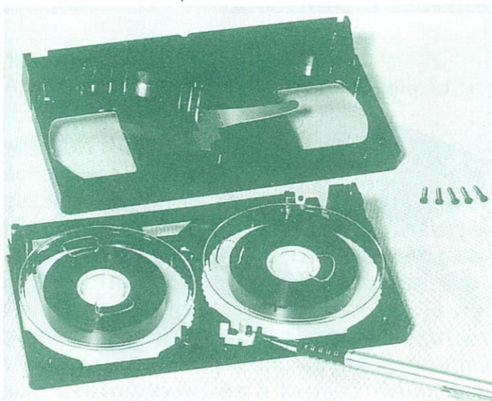
118. ábra Szétszedett VHS videokazetta. A szétszedési művelet nem ördögösség. A gyakorlat megszerzéséhez használjunk egy selejtes minőségű kazettát!
