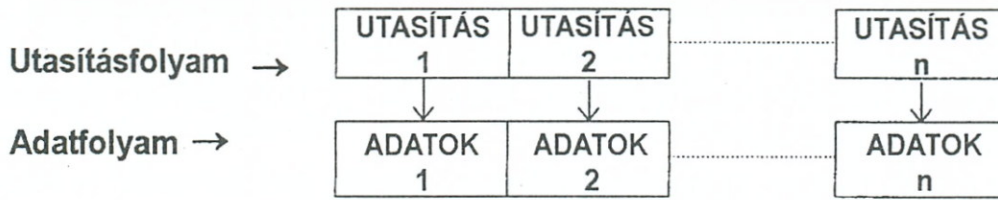
10. sz. ábra A SISD számítógép működése
