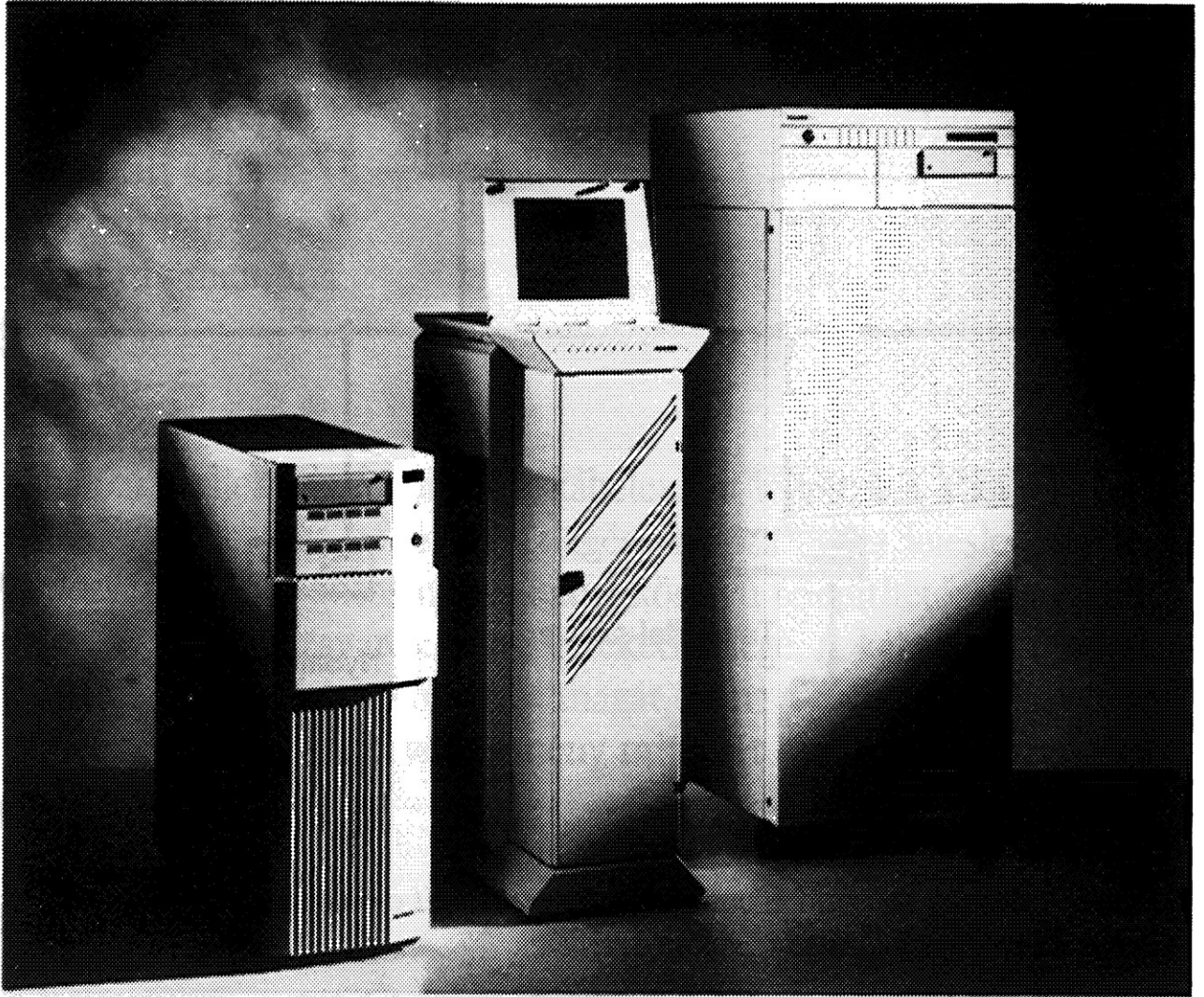
2-6. ábra. A szerverház iránt támasztott követelmények: jó hűtés, erős tápegység, elegendő hely a szereléshez, bővítésekhez
