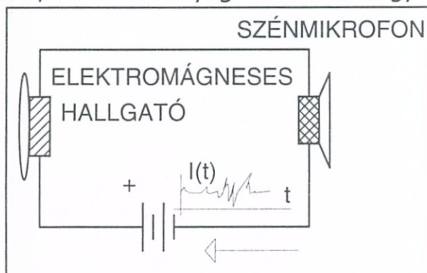
3-2. ábra A telefon működésének vázlata
