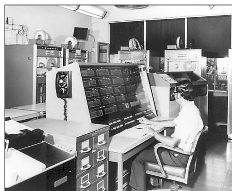
Megjelennek a mágnesszalagos háttértárolók, a képen a BRLESC-II számítógép látható Fotó: az USA hadserege
