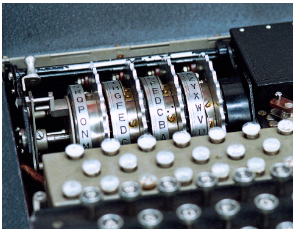
12. ábra Egy négyrotoros Enigma-variáns - közelebbről
