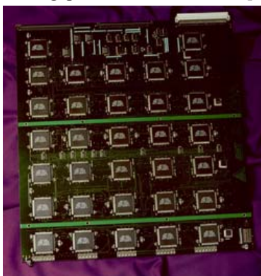
21. ábra Deep Crack egy alaplapja
