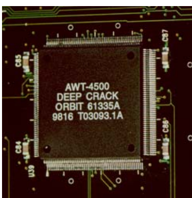
22. ábra A Deep Crack chip
