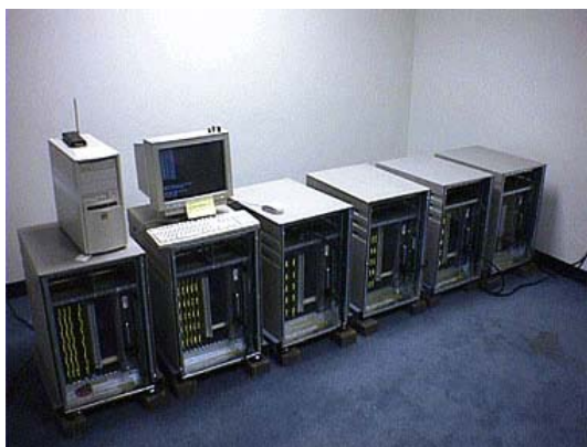
23. ábra EFF Deep Crack és a vezérlő PC
