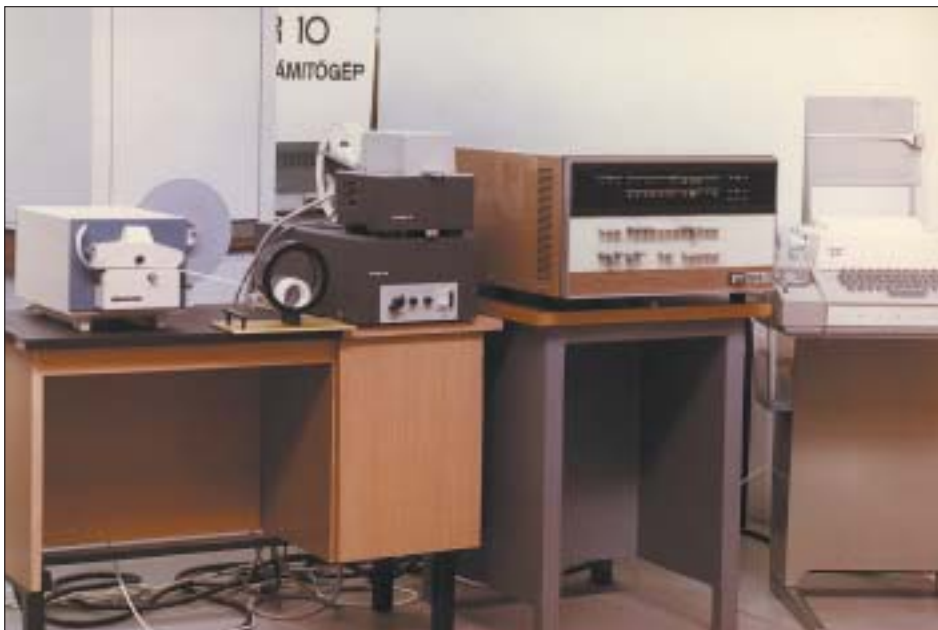
5. kép TPA-i. Baloldalon lyukszalag-perifériák, középen a TPA-i, jobb oldalon teletype
