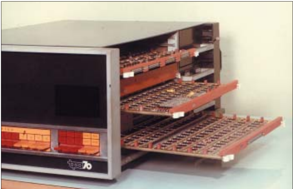
8. kép TPA-70 kinyitva, jól látszanak a nagy kártyák
