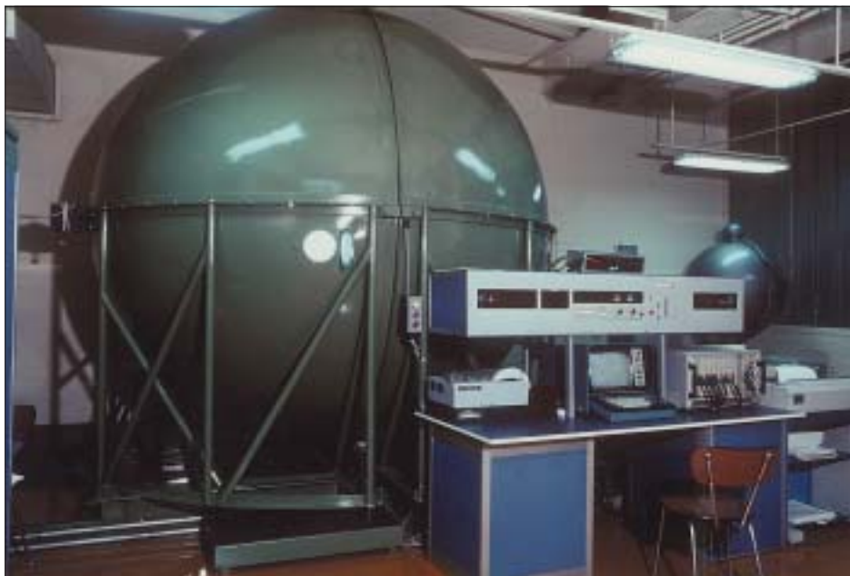
19. kép Fényforrás-karakterisztika mérés Intelligens CAMAC-kal a Tungsram Rt-ben
