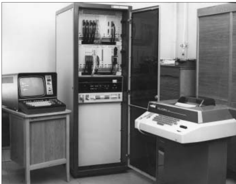
Háromtengelyű neutron spektrométer a KFKI-ban TPA-i-vel és két CAMAC kerettel
