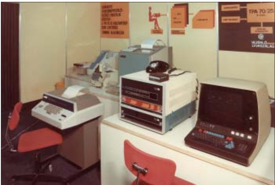
9. kép TPA-70/25 számítógép a BNV-n, baloldalon teletype, lyukszalag, kártyaolvasó és sornyomtató, jobboldalon display konzol
