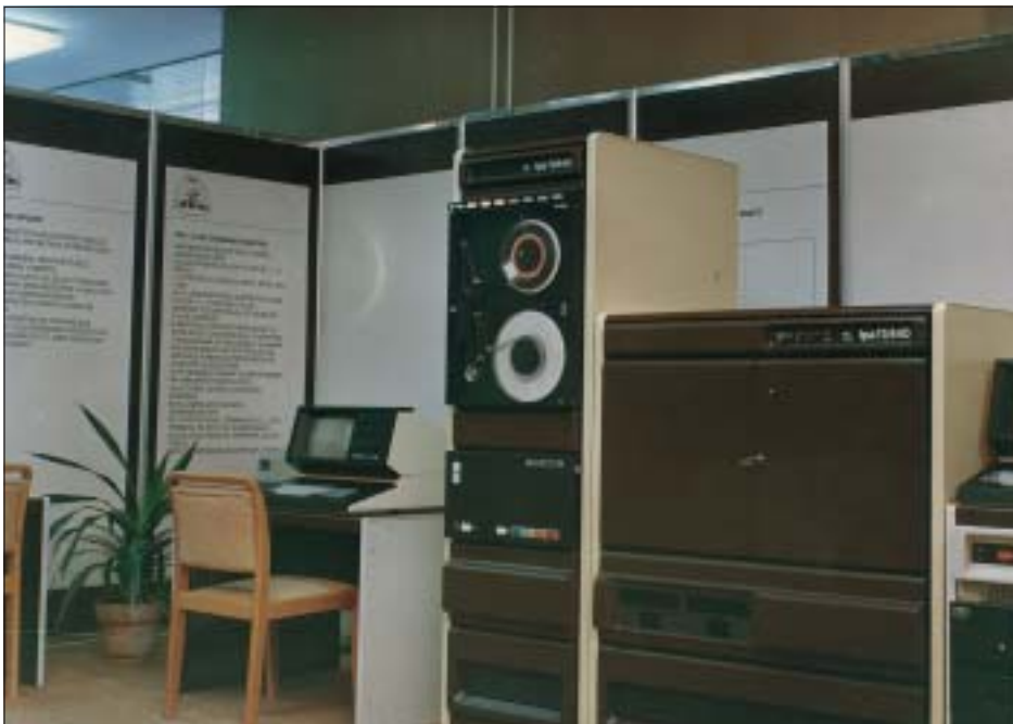
12. kép Jobboldalon széles keretben TPA-11/440, mellette balra diszk és mágnesszalag perifériák
