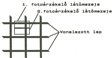
8. ábra. Optikai egér működési vázlatla (függőleges mozgásérzékelők)
