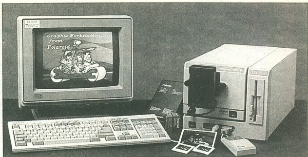
A Cebüt '91-en a Polaroid bemutatta képernyőfotózó grafikai munkaállomását, amely videóról és grafikai programból egyaránt tud képet készíteni.
