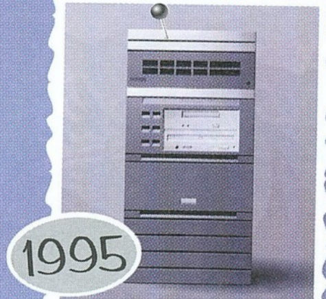
OakFire SuperTurbo 120 szerver 4x120 MHz CPU, 320 MB RAM
