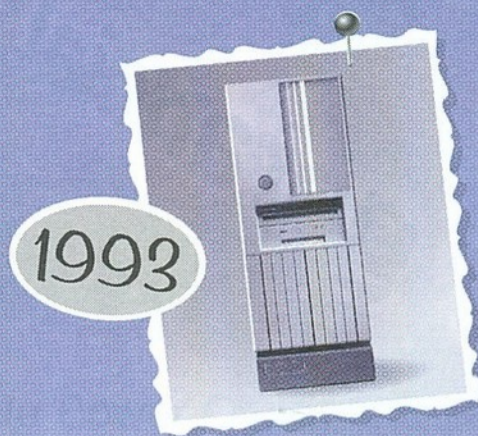
ZanzaServ 5 DVX szerver 1x40 MHz CPU, 64 MB RAM
