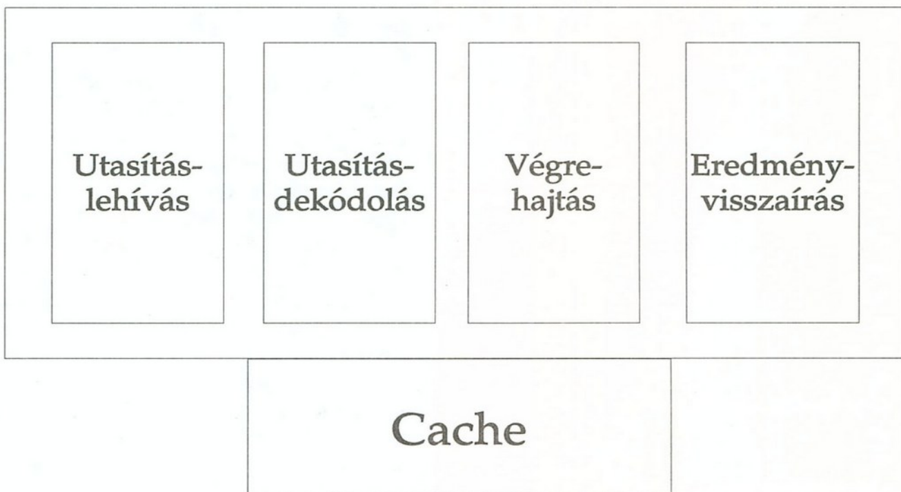
A picoJava egyszerű, négyfokozatú utasításvégrehajtása
