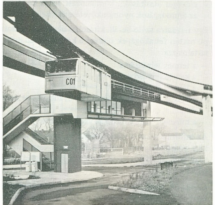
2. ábra Lineáris motoros hajtású függőspálya-szállítókocsi (DEMAG Fördertechnik)
