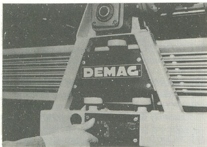
1. ábra A DEMAG Systembahn célvezérlésű szállítókoszija
