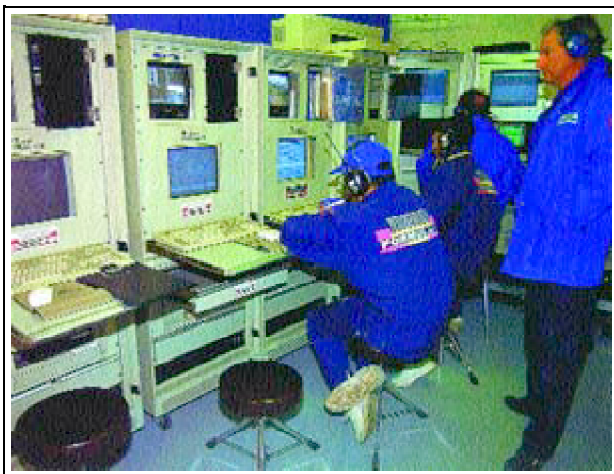
Távadatgyűjtő számítógépek a Tyrrell-Yamaha computer motorhome-jában.
