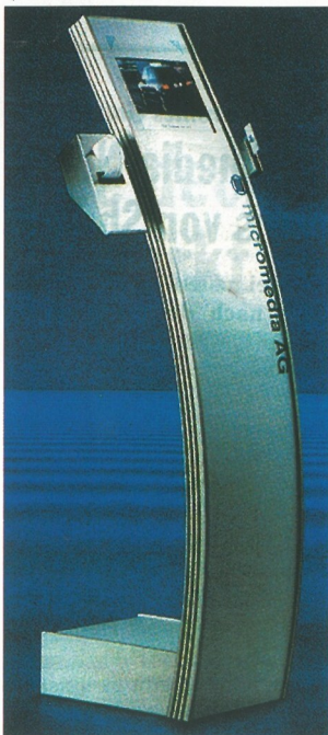
A Micromedia POS-termináljába egy Pentium MMX számítógépet rejtettek
