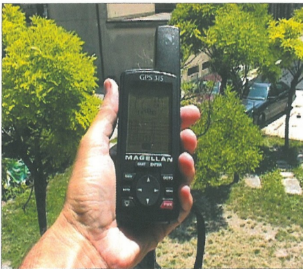
A kézre álló és könnyen kezelhető GPS 315 sok ezer település koordinátáit tartalmazza
