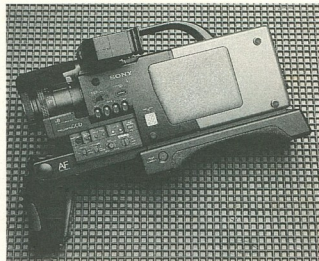
A Sony CCD V-200 E videokamera fölbontása 495 000 képpont és legkisebb expozíciós ideje negyvezred másodperc
