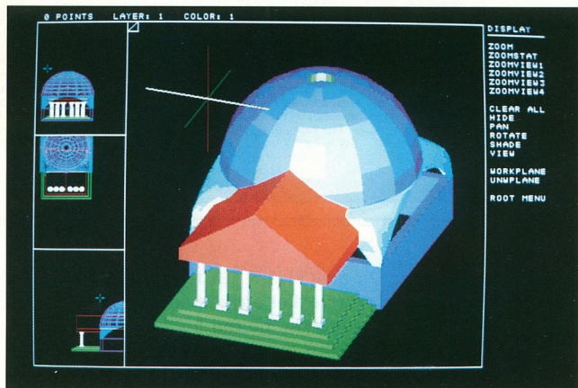
DesignCAD 3D: A Pantheon kupoláján jól megfigyelhető, ahogy a szilárdtestként kezelt héjszerkezetből egy henger segítségével kivágták a világító ablakot
