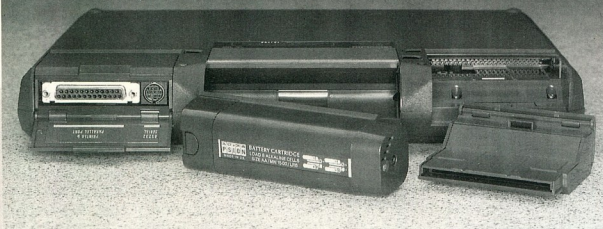
Hátulról: a csatlakozók bemélyedései a párhuzamos és soros csatlakozással (balra), valamint az elemtartó láthatók
