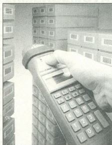
MS10 lézeralvasóval egybeépített kézi számítógép
