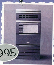
OakFire SuperTurbo 120 szerver 4x120 MHz CPU, 320 MB RAM
