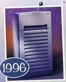
Sun Ultra Enterprise 5000 szerver 2x167 MHz CPU, 768 MB RAM
