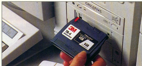
A Travan kazetták egyedülálló formája hosszabb és szélesebb szalag befogadására alkalmas
