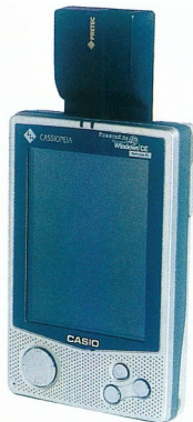
Compact Flash modem: a kilógó részben van a telefoncsatlakozó
