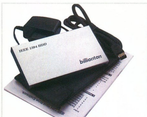
Billinton: a FireWire változat csak külső tápegységgel használható
