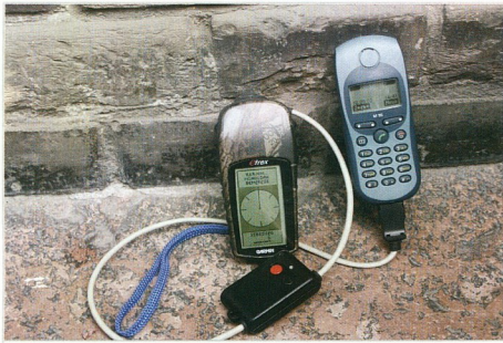
KGPS: kábel a telefon és a kézi GPS csatlakoztatására
