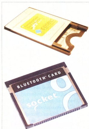
PC-kártya és socket: az egyiket noteszgéphez, a másikat pedig kézi számítógéphez csatlóztuk
