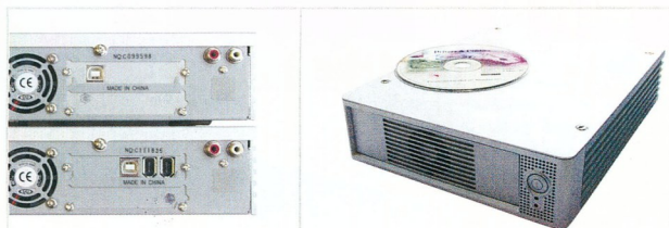
Billionton External Box: az egyforma kialakítású dobozok közül az USB 2.0-s modell jóval olcsóbb, de olykor szükség lehet a FireWire változatra is
