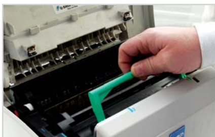
1 A tonerkazetta kiemelése: óvatosan, a fülénél fogva
