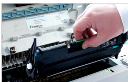
3 A dob kiemelése: óvatosan, erőltetés nélkül
