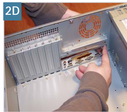
2D Ház előkészítése: csatlakozók hátlapjának behelyezése
