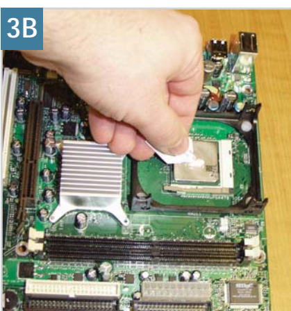
3B CPU-hűtés: ne vigyük túlzásba a szilikonzsír használatát
