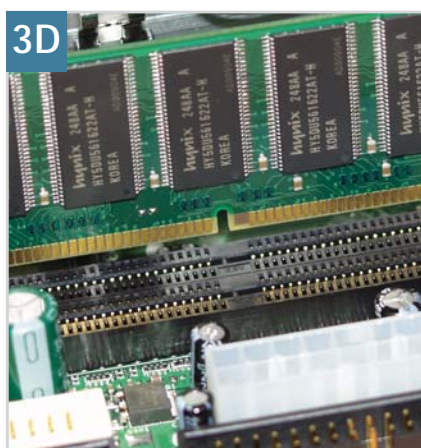
3D RAM beépítése: figyeljünk a memóriamodulon lévő rovátkára
