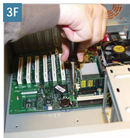
3F Alaplapp beszerelése: a csavarokat érzéssel húzzuk meg
