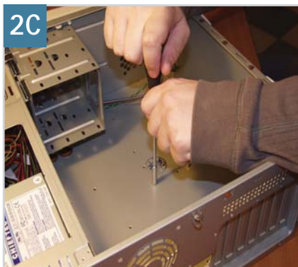
2C Ház előkészítése: távtartók becsavarozása
