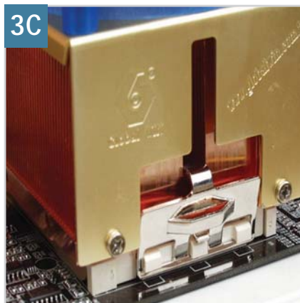
3C Hűtő beszerelése: három ponton felfekvő rögzítés
