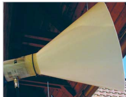
Elkészült: tető alá szerelve az antenna a nagy tölcserrel
