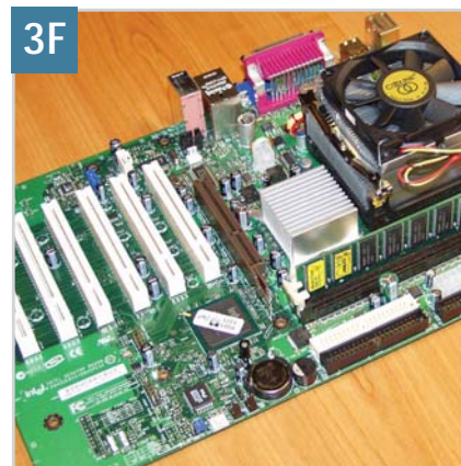
3F Előkészített alaplapp: most már beszerelhető a házba
