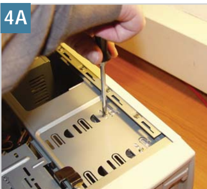
Meghajtók beszerelése: oldalanként legalább 2-2 csavarral
