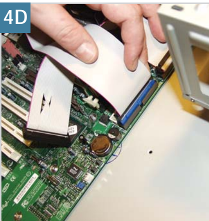
IDE-kábel: bekötés az alaplapi csatlakozóba
