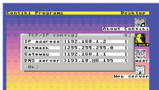
C64 a hálón: TCP/IP-beállítások Contiki alatt
