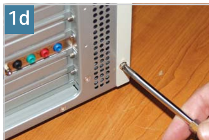
Szétszerelés: oldjuk a ház oldallemezének rögzítő csavarjait, s távolítsuk el a lemezt
