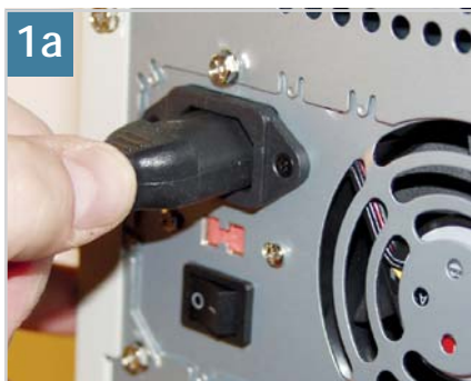
Áramtalanítás: a tápon található kapcsolóval áramtalanítsuk a gépet, majd húzzuk ki a hálózati kábelt
