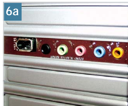
6a Hátlap: figyeljük meg, hová kell csatlakoztatni a hangszórót ill. fejhallgatót
