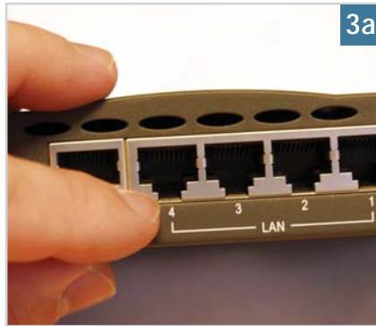
LAN-portok a routeren: a PC-vel való kommunikáció kapui
