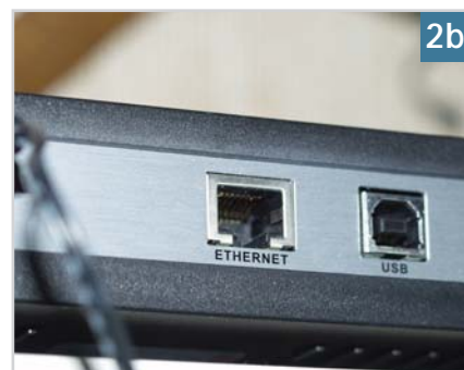
A DSL-modem Ethernet-csatlakozója: ide kössük be a modemtől jövő kábelt
