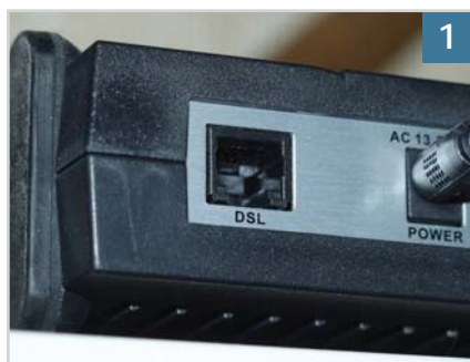
Az ADSL-modem DSL-aljzata: ide csatlakozik a telefonvonal a szűrő áramkörön keresztül
