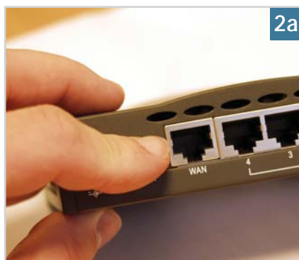
A router WAN-csatlakozója: kapcsolat a világra felé
