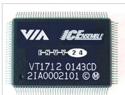
VIA Envy24: a legtöbbet használt audio-kontroller áramkörök egyike, számos hangkártya alapja
