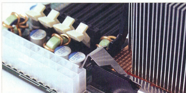
Tyant S2668ANR Tiger i7505: a rossz tervezés eredménye, a hűtő a tápcsatlakozón keresztül rögzíthető
