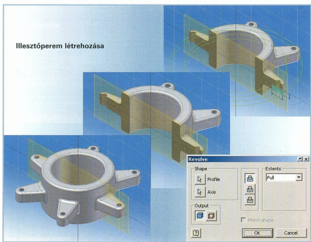
Az elkészült alkatrész színnel, rövidüléssel, vetülettel ábrázolva
