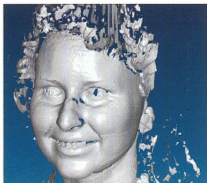
Pontfelhő árnyékolt háromszögmodelles megjelenítésben
