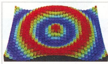
Látásjavítás: a mikrotükrök elfordulási diagramja, optimális szem esetén. A valóságos esetekben a minta lényegesen szabálytalanabb
