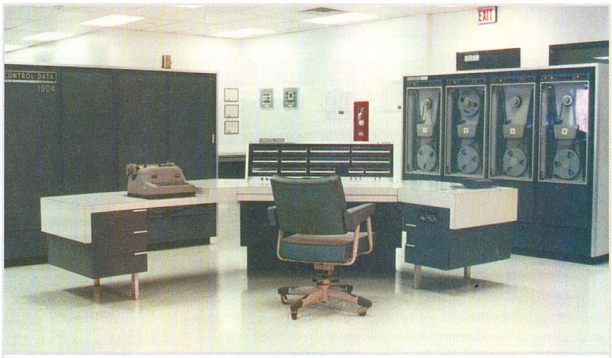
Paradigmaváltás (CDC 1604): a CDC első tranzistor alapú gépe selejtes tranzistorokból készült
