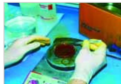
Savfürdő: erős salétromsavban oldják fel a házat, ám a szilícium sértetlen marad
