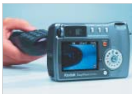
Teszt – digitális kamerával: egy digitális kamera segítségével könnyen meggyőződhetünk távírányítónk működőképességéről
