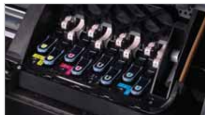
A gyors működés titka: a nyomtatófejek megkettőzése
