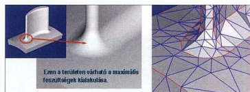
H-típusú elemekkel létrehozott háló
