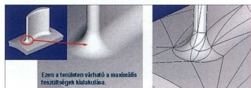
Pro/ENGINEER által generált P-típusú elemekből álló háló (pontosabb geometriai közelítés)
