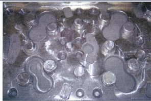
Alumíniumból öntött vákuumformázó betét csiszolás közben
