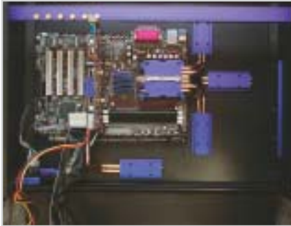
TNN 500A belülről: heatpipe-pal a tökéletes csendért
