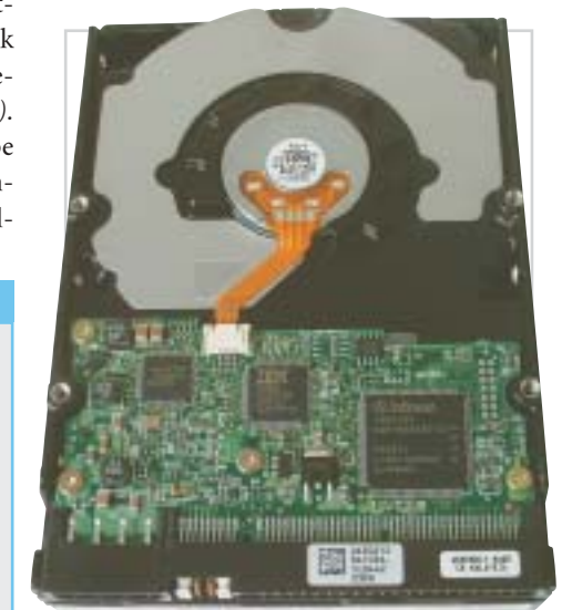
Hitachi: középen ott virít az IBM gyártotta áramkör, a konstrukció is tölték származik
