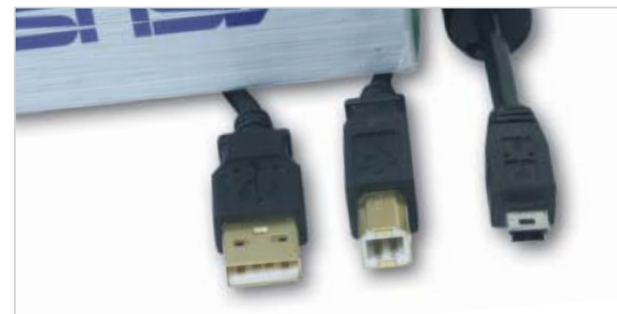
Szabványos USB-csatlakozók: USB A, USB B és USB mini B
