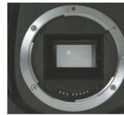
Érzékelő: a tükörreflexes gépekben nagyobb méretű található
