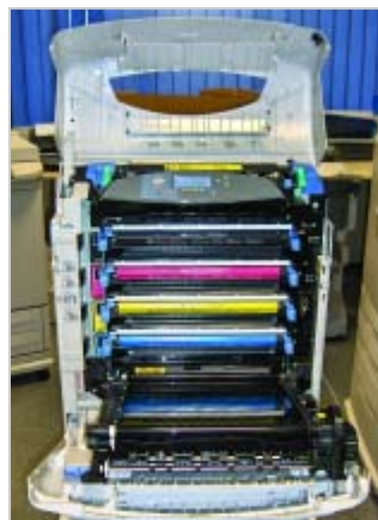
HP Color LaserJet 5550: a nyitott előlap mögül élénk tárul a belső
