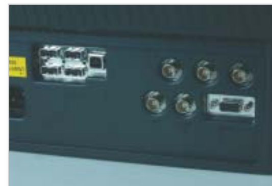
LG F920P: USB-elosztóval és BNC RGB bemenettel
