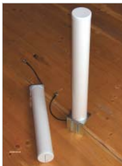
Antenna: álló kör- és fekvő irányítósugárzó
