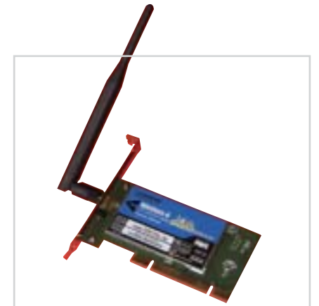
PCI-kártya: az asztali gépek WLAN hálózatba való integrálásához
