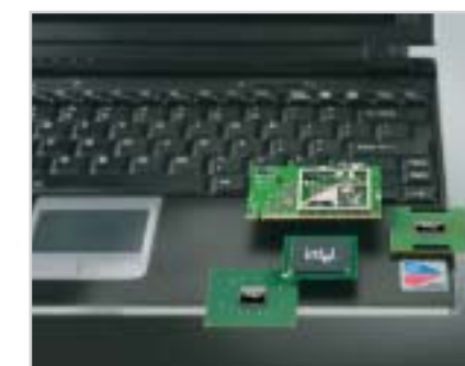
Centrino-feltételek: Pentium M processzor, 915-ös lapkakészlet és PRO/Wireless hálózati adapter
