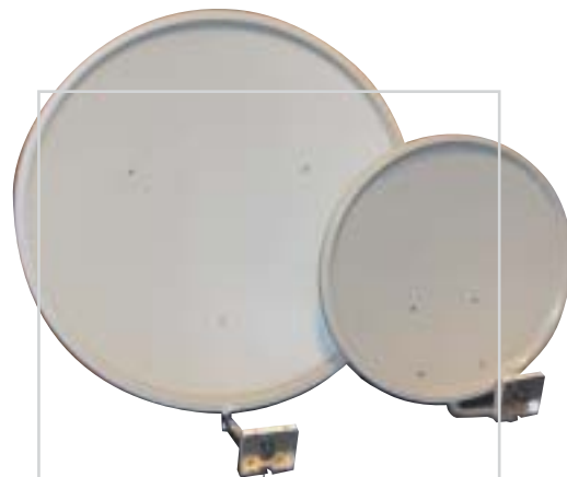
Parabola antenna: nagy távolságú kapcsolathoz
