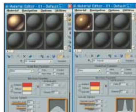
Fényesség: a 3ds max szemléletesen, egy grafikonnal mutatja meg a csúcsfények alakulását. A Specular Level a fényesség mértéke, a Glossiness (simaság) a kiterjedése
