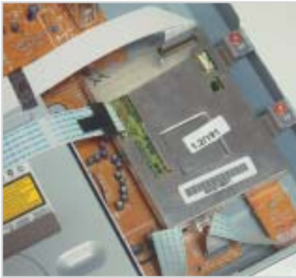
JVC: MPEG2-es tömörítőegység
