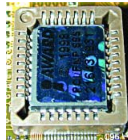
A múlt: a BIOS-t régebben csak a hardverelem cseréjével lehetett volna „leváltani”
