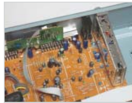
Belső kép: a tuner és a videocsatlakozók
