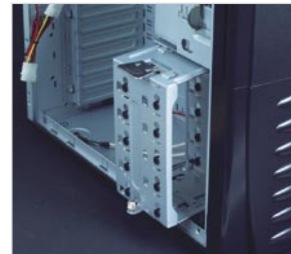
Antec SLK3000B: kiszedhető HDD-tartó
