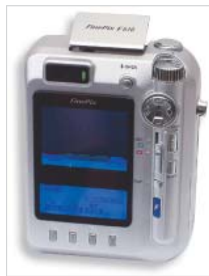
FinePix 610: a függőleges kialakítás előnyei. Megfigyelendő a négy változó működésű gomb az adat-LCD alatt
