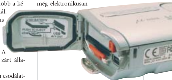
Olympus mju: egyetlen, tömített fedél alatt az akku, a kártya és az USB-csatlakozó
