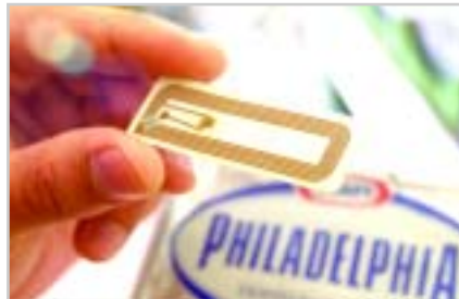
A címke: a kis barna pötty a lapka, a vonalak alkotják az anténát
