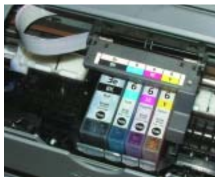
Canon IP 3000: a tinták külön-külön, átlátszó kannácskákban
