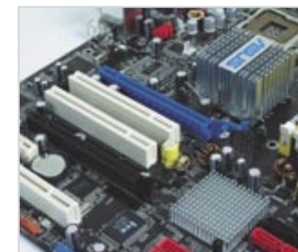
Dupla PCIe x16 foglalat: az ASUS elkészítette, már csak támogatni kell (SLI, CrossFire)
