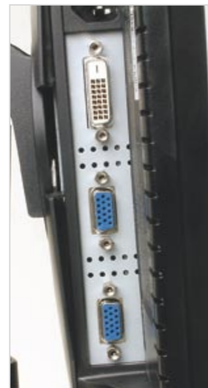
Egy professzionális monitor hátoldala: két D-Sub- és egy DVI-bemenet közül is választhatunk
