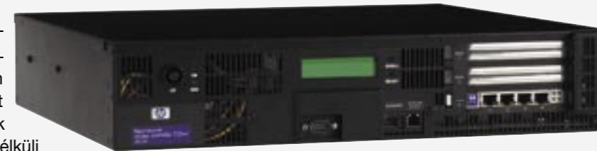
A 720wl Access Controller feladata a felhasználók azonosítása
