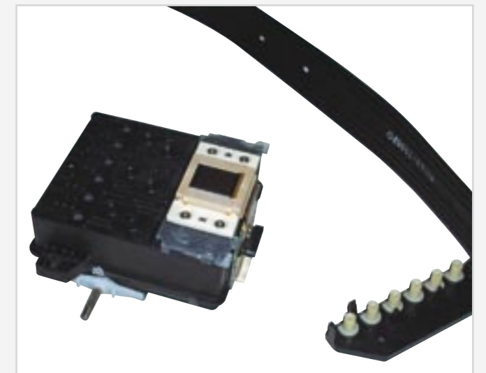
HP 8250: a kiszertelt fejegység és a hozzávezető csövek
