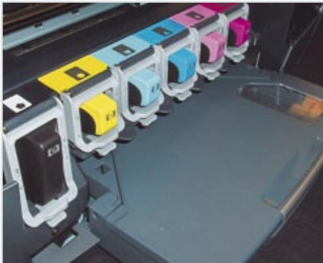
HP 8250: a nyomtató fedelének felnyitása után láthatóvá válnak a világosszürke kenyelekkel rögzített festéktartók
