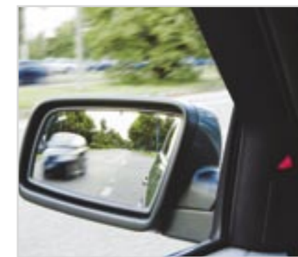
Vörös fény a tükrök mellett: a Blind Spot Detection jelzi, ha egy másik jármű van a vezető által nem látható területen
