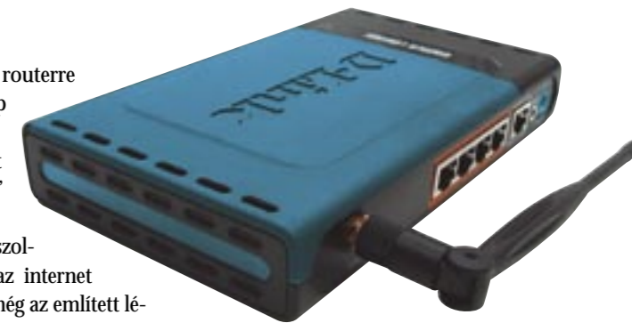
WLAN router: antennával a kábelrengedeteg ellen
