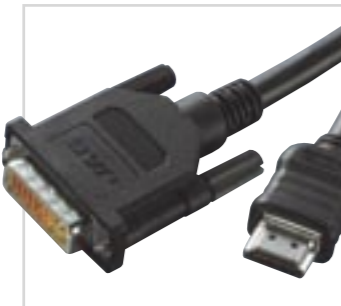
DVI-HDMI kábel: a UDI mindkettővel kompatibilis lesz
