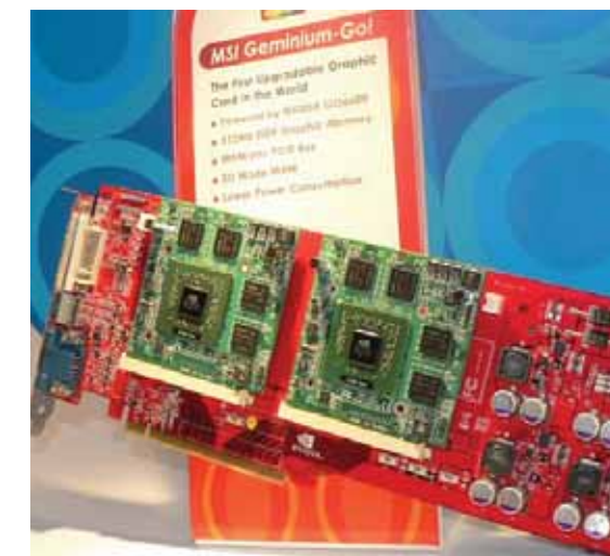
MSI bővíthető VGA-kártya: érdekes koncepció, mobil technológiával fűszerezve
