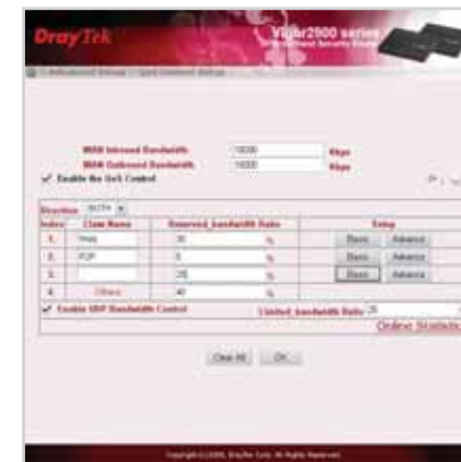
Quality of Service: előnye, hogy a sávszélesség protokollok szerint is elosztható, prioritizálható – ezt még a hardveres tűzfalak sem mind tudják
