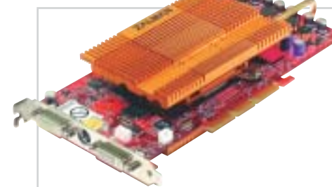
Zalman ZM80C-HP: a legnépszerűbb néma VGA-hűtő
