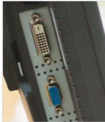
Csatlakozók: a DVI- (felül) bemenetet használva javul a képminőség és a képkezelés
