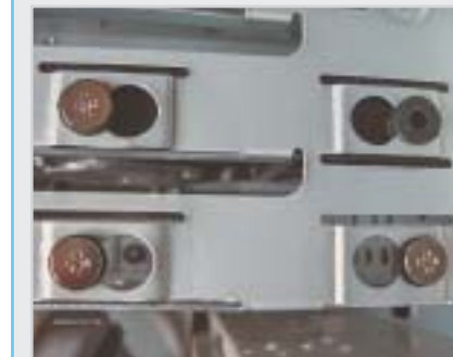
Gumicsillapítás: az apró alkatrészek jelentősen csillapíthatják a zajt
