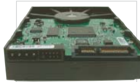
Maxtor: a SATA csatlakozó mellett a régi tápcsatlakozó is rajta van
