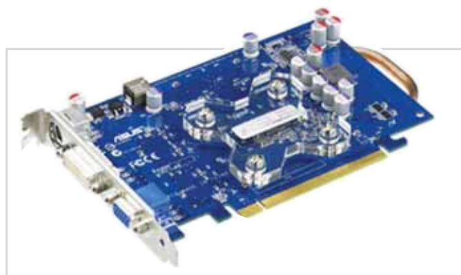
ASUS ReverseCool hűtés: egyelőre csak gyenge GPU-knál
