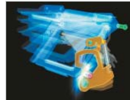
Tükör: a felcsapódás rezgése kivédhető
