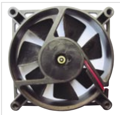
Ventilátor hátulnézetben: középen a rettegett Seeger-gyűrű
