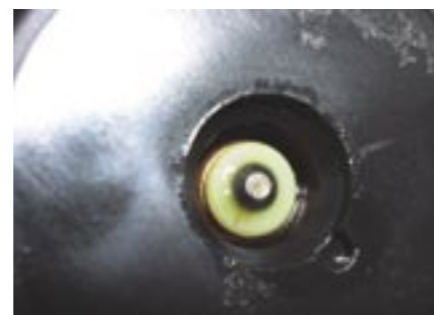
A Seeger-gyűrű közelről: már a megközelítése is nehézkes
