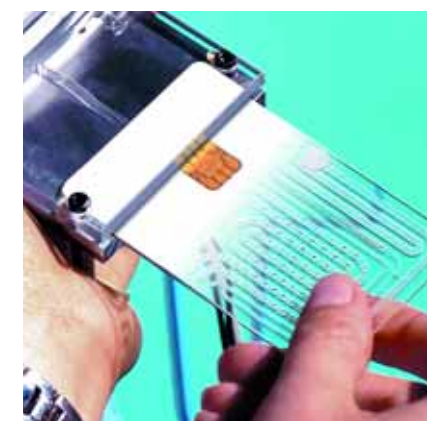
Egyszerű mozdulat: a biochipkártyát betoljálják egy kézi eszközebe, amely teljesen automatikusan vezérli a folyamatot, és megmutatja az eredményt
