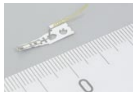
A merevlemezek nagy precizitású eszközei: ezt jól mutatja az olvasófejek parányi mérete is
