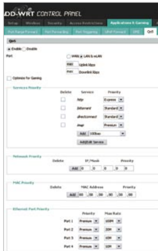
Forgalomszabályzás felsőfokon: a LAN és a WLAN adatforgalmát MAC-cím, hálózati cím vagy protokoll szerint is szabályozhatjuk
