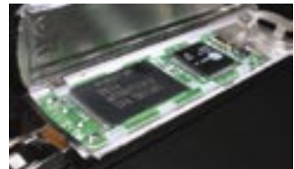
NAND chipes USB kulcs: több száz MB-ot félelem nélkül
