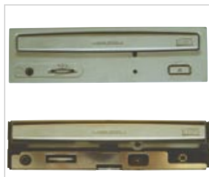
Kezdetek kezdete: az előlap eltávolításával indul a munka
