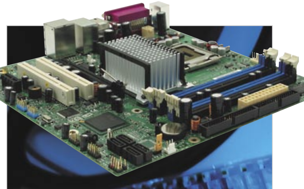
Intel 945-ös alaplap: jó szolgáltatások, stabil működés, passzív hűtés
