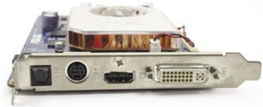
HDMI kimenet az Asus 7600GT-n: jövőre már minden VGA kártyán standard lesz
