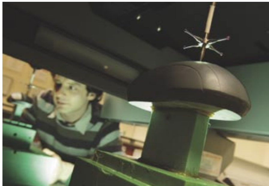
Egy prototípus digitalizálása 3D-s szkennelvel: 50 mikronnyi pontossággal dolgoztak
