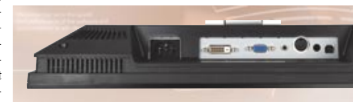
DVI bemenet: szerencsére a közép- és felsőkategóriában általános
