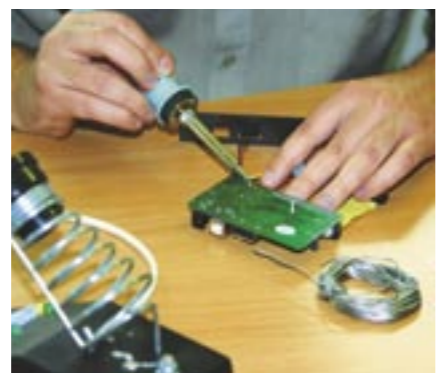
Csak egy kis kényesség kell: forrasszuk ki a tápcsatlakozót a helyéről
